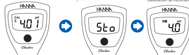
Use pH 4 o pH 10 para realizar una calibración de dos puntos. El valor se reconoce automáticamente y se muestra con el indicador de estabilidad parpadearante
