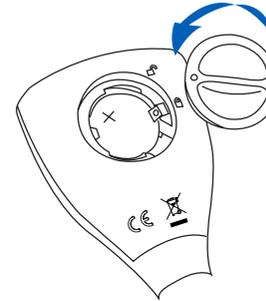
Para cambiar la pila CR2032 Li-ion, gire hacia la izquierda la tapa situada en la parte posterior del medidor. Retire la tapa y reemplace la pila con la cara + hacia arriba.
