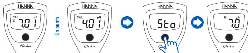
Si usa como primer punto de calibración la solución tampón pH 7 el indicador de estabilidad parpadeará
