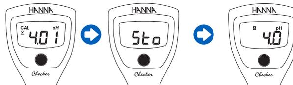
Si las soluciones de tampón pH 4 o 10, se usan como primer punto se reconocerá el valor del tampón y se mostrará con el indicador de estabilidad parpadearante.
