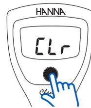
Coloque el medidor en el modo de calibración. Mantenga pulsado ON / OFF hasta que aparezca "CLR". El medidor estará ahora en el modo de calibración por defecto. No se mostrarán etiquetas en el modo de medida hasta que no se realice la calibración.
