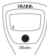
HI98115 GroPro cuenta con indicador de batería baja. Cuando la batería se está agotando, el icono de batería parpadeará en la pantalla. Cuando la batería se haya agotado aparecerá en la pantalla el texto "Err" y posteriormente se apagará
