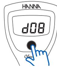
Desde el modo medida, mantenga presionado el botón ON/OFF. El medidor pasará por "OFF," y "CAL," hasta llegar a la opción de auto-apagado. La configuración por defecto es de 8 minutos ("D08"). Presione el botón ON / OFF para cambiar. "D60" significa apagado automático después de 60 minutos, y "D-" desactiva la función de apagado automático. Mantenga pulsado el botón para salir del menú.
